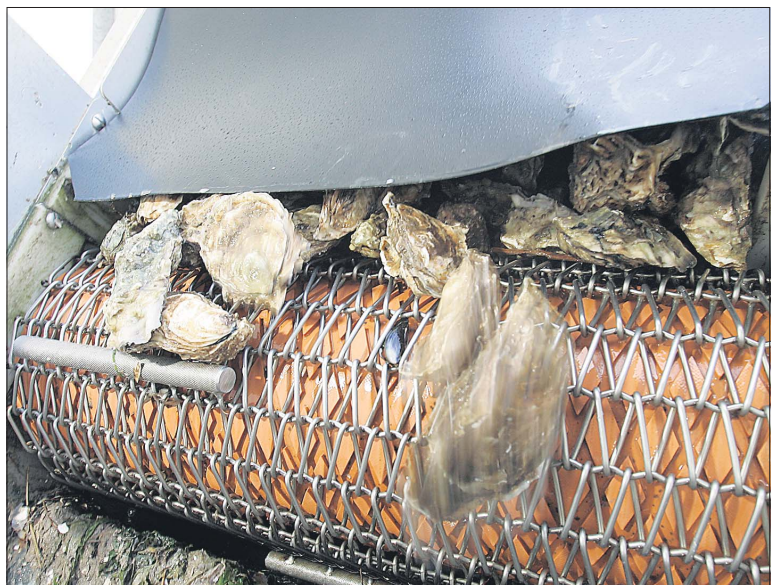
Avant de passer sur la bande les huîtres seront lavées automatiquement.
